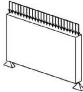
Figura 1.4. Viga de pared
