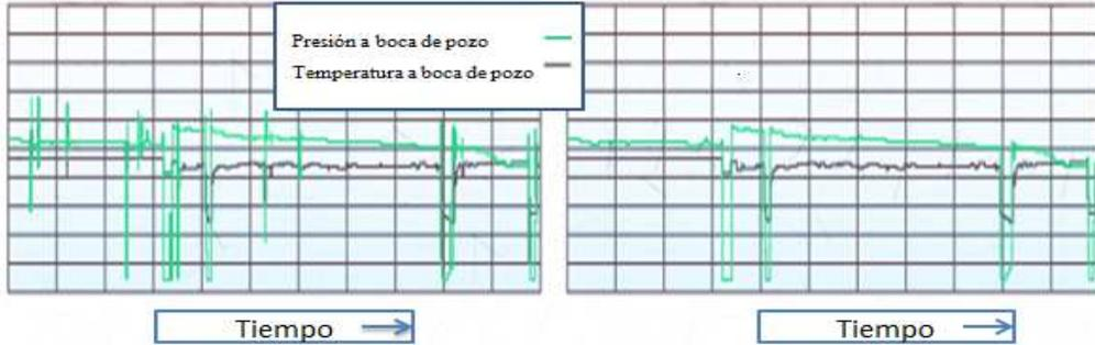
**Figura 1.8.** Limpieza y reducción de datos ruidosos, el registro de la izquierda muestra datos de alta frecuencia con ruido. El de la derecha muestra el mismo registro, libre de ruido y listo para ser empleado con los programas de modelado<sup>12</sup>.
