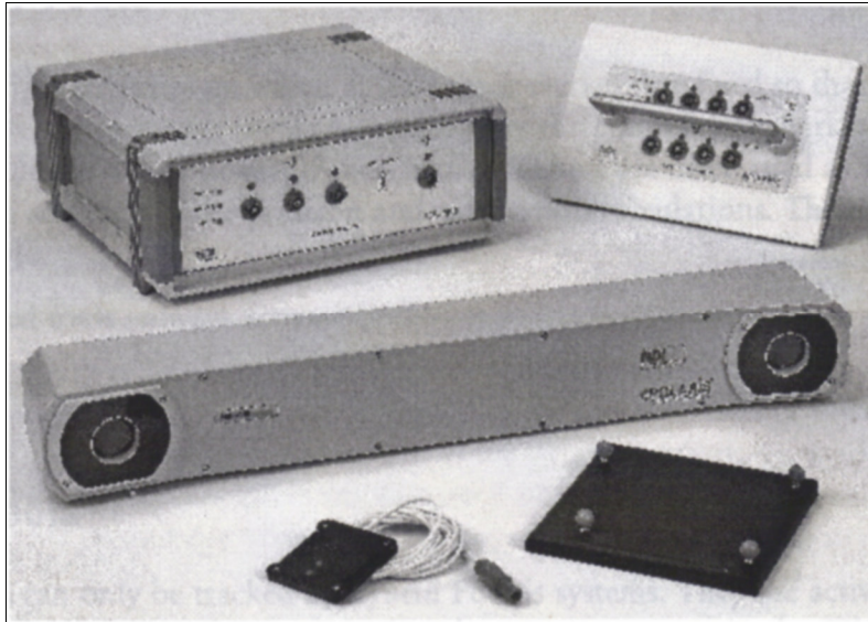
Figura 5. Sistema Polaris Híbrido. Se puede observar la unidad de interfaz de herramientas, la unidad de expansión de puertos, el sensor de posición, una herramienta activa y una pasiva [36].
