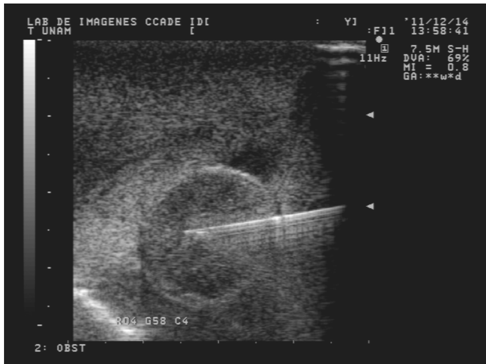
Figura 31. a) Adquisición de imágenes para la generación de un volumen de la aguja insertada en el maniquí de alcohol polivinílico. b) Imagen de ultrasonido de la aguja dentro de la uva.
