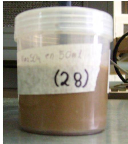
**Figura 3.1.** Pulpa del material 1 durante la agitación, preparada con la solución acuosa del sulfato ácido de potasio.
