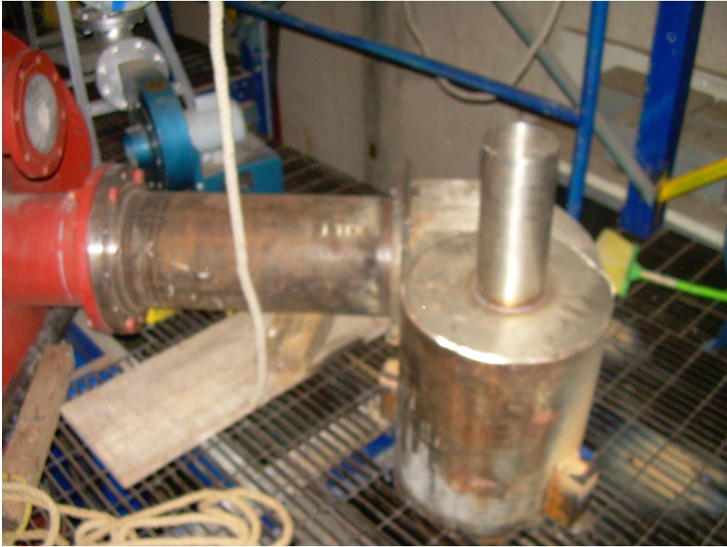
Figura 2-3: Vista lateral del ciclón colector de partículas (elaboración propia).
