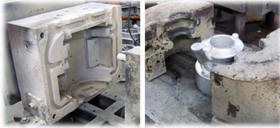
Figura 11. Fundición de aluminio en moldes permanentes.
