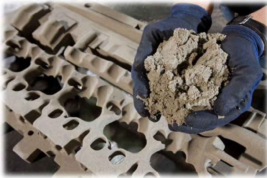
*Figura 1. Corazón para fundición en molde de arena.*
