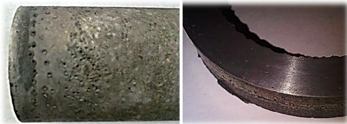
*Figura 89. Defectos de porosidades durante el proceso usando pintura de grafito.*
