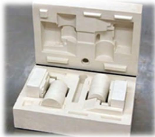
*Figura 9. Molde de yeso para fundición.*
