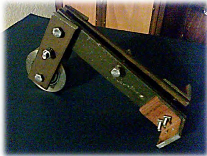
*Figura 80. Polea superior ensamblada a su base.*
