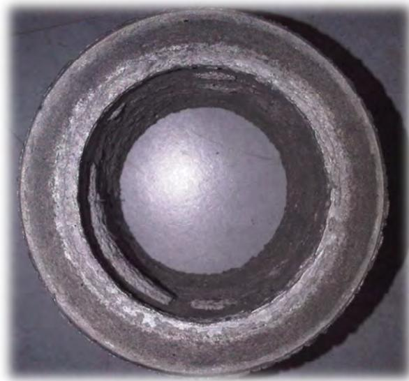
*Figura 91. Ecurrimiento en la superficie interior del molde.*
