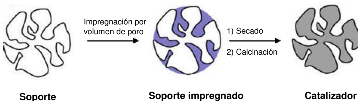
Figura 2.4.1. Esquema de preparación de catalizadores por el método de impregnación incipiente. Los poros del soporte se llenan con disolución después de la impregnación (en azul). El catalizador final se muestra en gris indicando que la fase activa se depositó [30].
