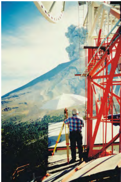
Figura 52. Mediciones con EDM (Leica DI3000S) desde Tlamacas en el flanco norte del volcán Popocatepetl. A la derecha distanciómetro Leica DI3000S
