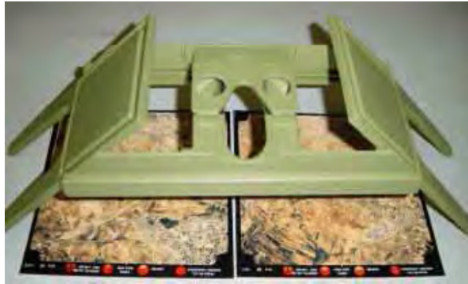
Figura 46. Estereoscopio de Espejos.
