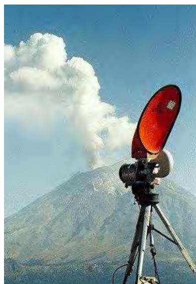
Figura 5 Enlace de la cámara de video montada en el cerro de Altzomoni, que sirve para observar de manera permanente el sector norte del volcán Popocatépetl (tomada de www.cenapred.unam.mx ).
