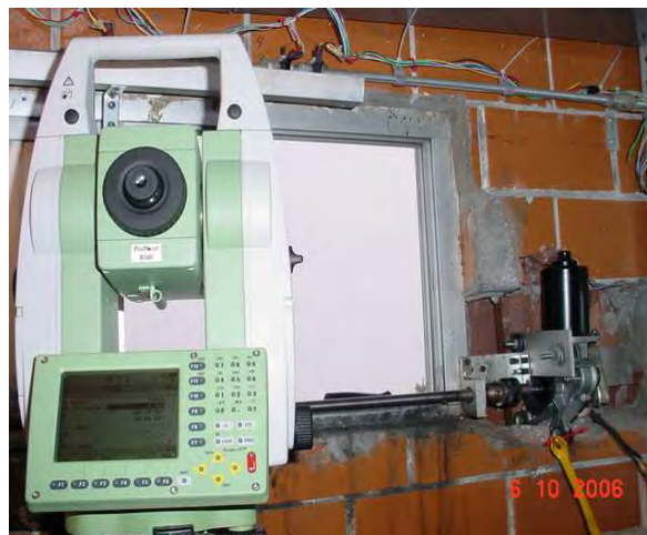
Figura 20. Estación robótica para medición de deformaciones en el flanco norte del volcán Popocatepetl.
