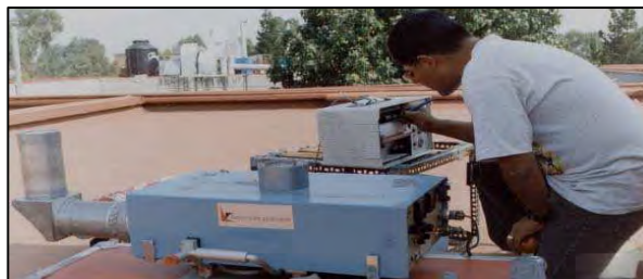
Figura 13. Espectrómetro de correlación para medición de \text{SO}_2 en el volcán Popocatépetl (tomada de www.cenapred.unam.mx )
