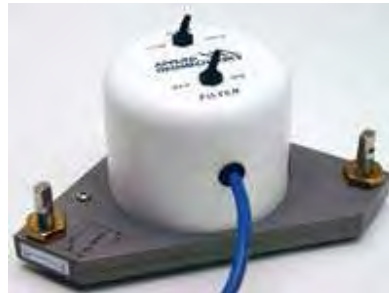
Figura 25. Inclinómetro electrónico como el instalado en la estación Canario.
