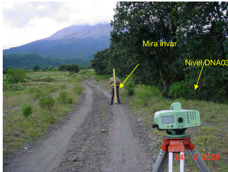
Figura 23. Nivel Leica DN03 y miras invar en código de barras.
