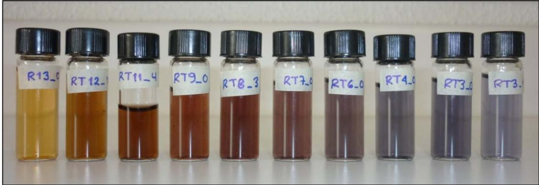
Figura 2.2. Soluciones coloidales producidas a diferente valor de pH. Se observa el cambio de coloración, debido posiblemente a diferente distribución de nanopartículas.
