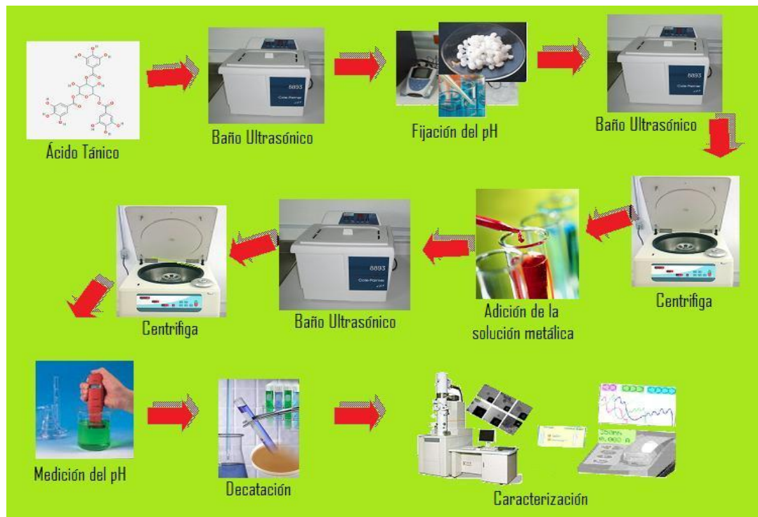
Fig.2. 1 Diagrama del proceso de síntesis de nanopartículas de plata.
