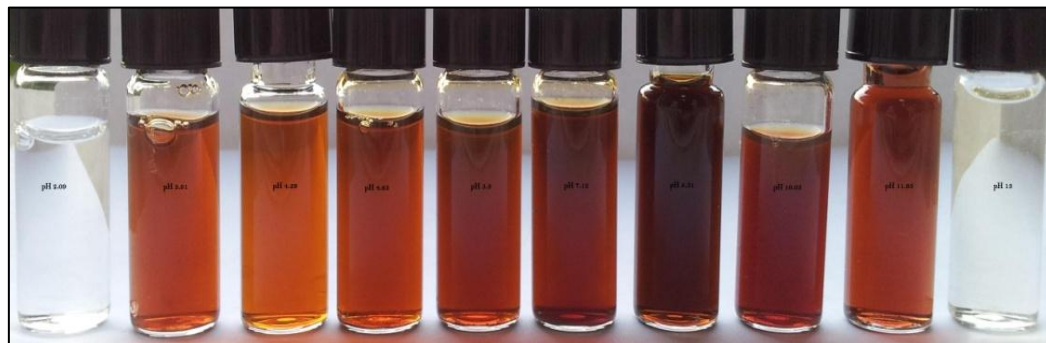
Fig.2. 2 Nanopartículas producidas, de izquierda a derecha pH 2.09, 3.81, 4.29, 4.63, 5.8, 7.12, 8.31, 10.05, 11.95 y 13.
