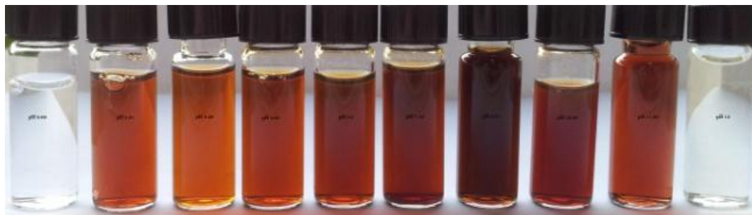
Fig.4. 2 Comparación de las tonalidades de las soluciones de las nanopartículas producidas, de izquierda a derecha pH 2.09, 3.81, 4.29, 4.63, 5.8, 7.12, 8.31, 10.05, 11.95 y 13.
