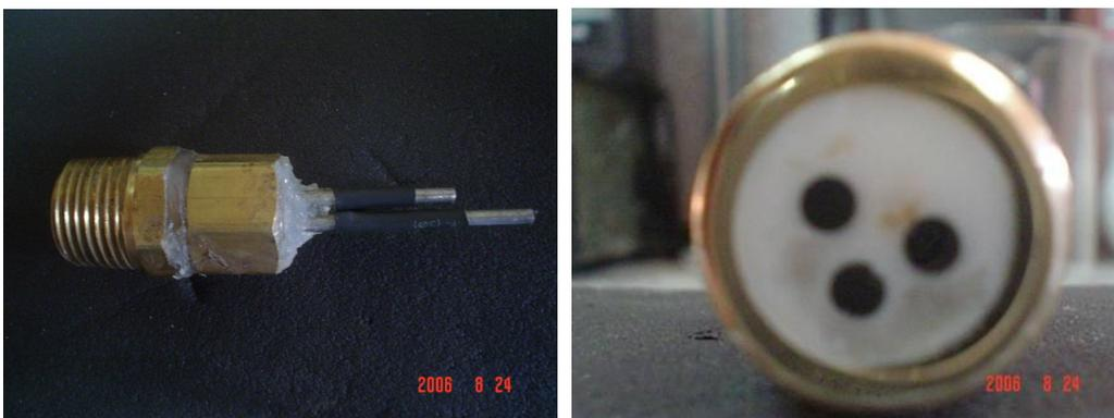
**FIGURA 2.1** Probeta cuproníquel 90/10 para las pruebas en la bomba de calor
