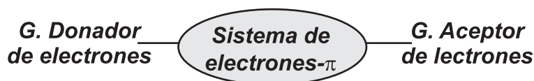
Figura 3.3: Estructura D-\pi-A : Sistema donador de electrones, grupo central con electrones- \pi , y el grupo aceptor de electrones; esta es la estructura más común de los cromóforos orgánicos utilizados en aplicaciones de óptica no-lineal de segundo orden.
