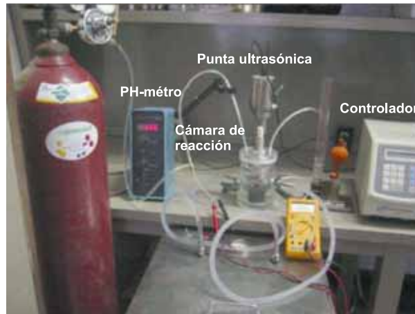
Figura 1.3: Fotografía con todos los accesorios necesarios para sintetizar y controlar la obtención de sonogel libre de catalizadores químicos: punta ultrasónica, cámara de reacción, baño refrigerante, tanque de gas, medidores de pH y temperatura.
