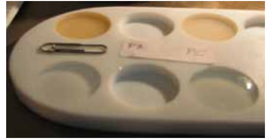
Figura 5.2: Fases sol pura y dopadas con disoluciones de PB-DR19 y PC-DR19 en THF depositadas en los contenedores/moldes de teflón de 2 mL.
