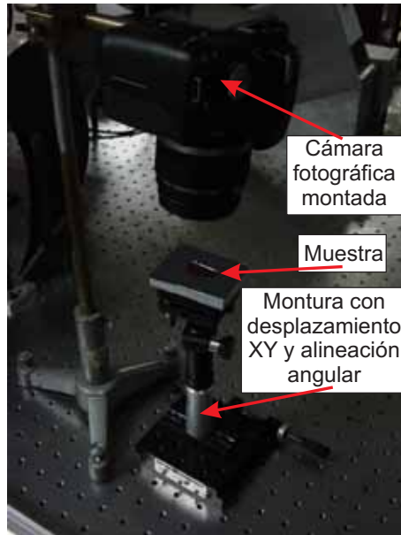
Figura 7.3: Fotografía de la instrumentación implementada para determinar la atenuación en las guías de onda planares (en la imagen no se observa el láser).
