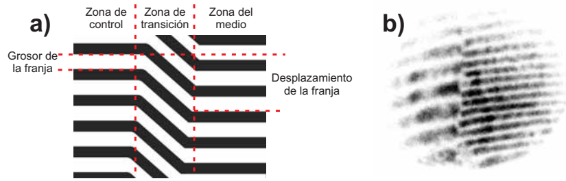
Figura 6.9: a) Esquema del desplazamiento de franjas de interferencia debido a un cambio del camino óptico provocado por una laminilla transparente, este desplazamiento se utiliza para medir el índice de refracción de los recubrimientos. b) Fotografía de un interferograma obtenido, del lado izquierdo del interferograma se encuentra el resultado de la referencia y del derecho se observa el desplazamiento provocado por la presencia de una muestra.
