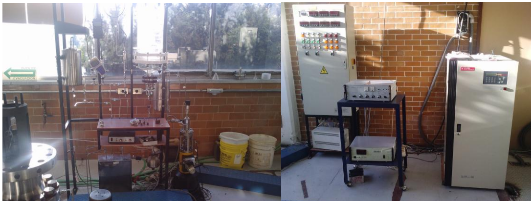
Figura 3.6. Simulación de las condiciones de un BWR en la autoclave MEX-01.
