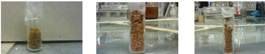
Como se observa en las imágenes, el extracto es un sólido café y este queda completamente seco. Se realizó una placa (CCF) en donde se observa que la cantidad de azúcares aumenta una vez que la muestra se somete a la liofilización, debido a que se elimina el agua del extracto, permitiendo así su concentración. En la mancha 4 de la placa se hace más visible la presencia de azúcares que en la placa en donde el extracto estaba en su forma original.
