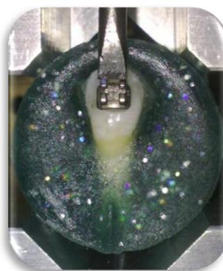
**Figura 21.** Colocación de la cizalla para la prueba de resistencia al desprendimiento
