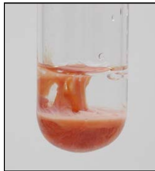
Imagen 5. Precipitado formado de la combinación de CHX con NaOCl. 15
