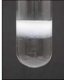
Imagen 6. Precipitado formado de la combinación de CHX con EDTA. 15
