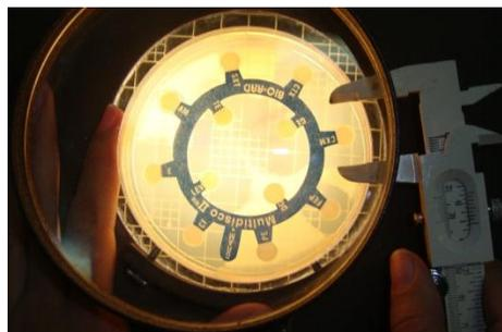
FIGURA 11. Medición del diámetro de la zona de inhibición, Fuente directa
