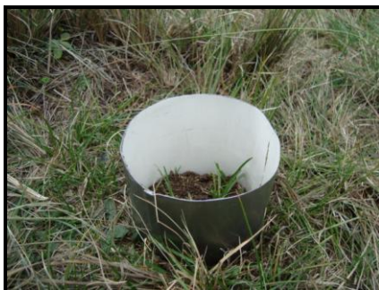
Figura 3. Obtención de muestra inalterada con caja tipo Kubiena.
