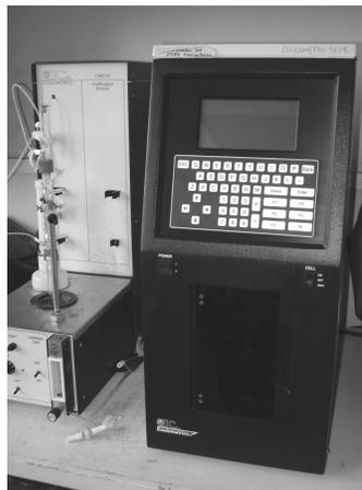
**Fig. 5-** Colulometro S014, utilizado para la determinación de carbono total (CIT y COT).
