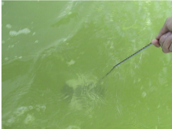
Figura 5.8. Procedimiento para la determinación de la turbiedad. A mayor profundidad todavía se observan los cuadrantes.
