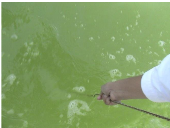
Figura 5.10. Procedimiento para la determinación de la turbiedad. El disco Secchi ya no se observa.
