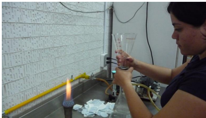
Figura 5.16. Procedimiento para la determinación de coliformes totales y fecales Colocación de matraz sobre matraz Kitasato.
