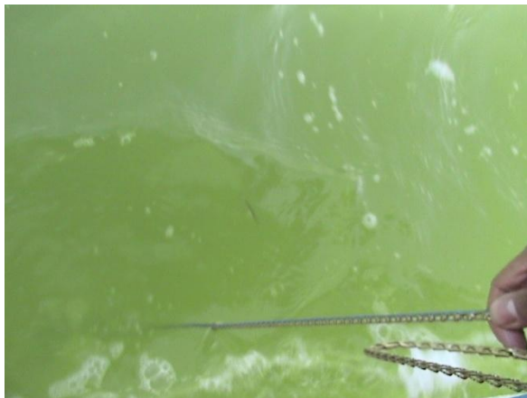
Figura 5.9. Procedimiento para la determinación de la turbiedad. Aumentando la longitud sumergida de la cadena, todavía se perciben los cuadrantes.
