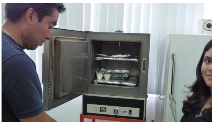
Figura 5.22. Procedimiento para la determinación de SST Secado a 105 °C durante una hora
