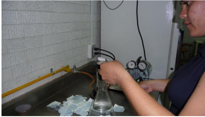
Figura 5.15. Procedimiento para la determinación de coliformes totales y fecales Toma de papel filtro con la ayuda de pinzas estériles.
