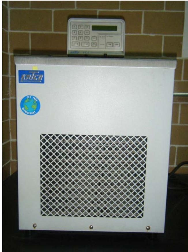
Figura 19. Baño térmico de pozo húmedo.
