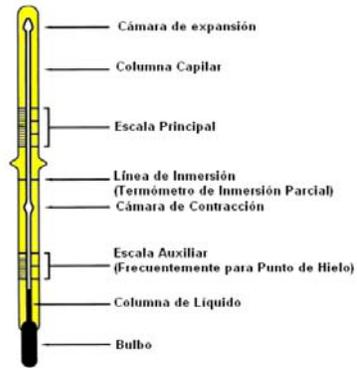
Figura 10. Partes de un termómetro.
