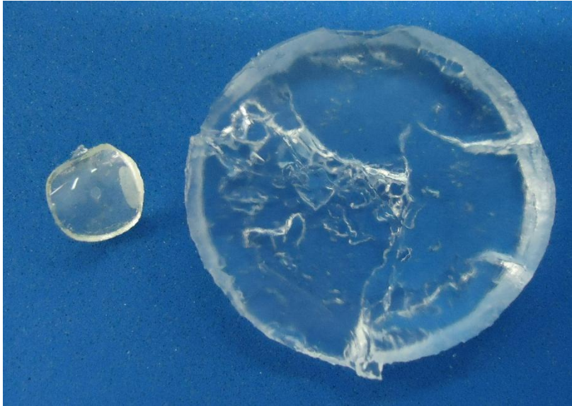
Figura 9. Comparación física del hidrogel de DMAEMA con 0.1% de agente entrecruzante hinchado a pH 5.0
