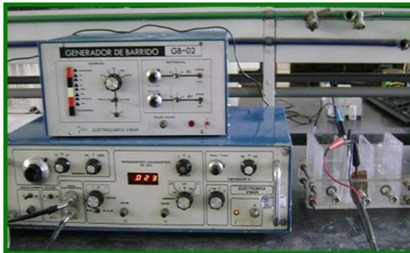
*Figura 2-4. Potencióstato - galvanostato VIMAR modelo. PG-5RV.*
