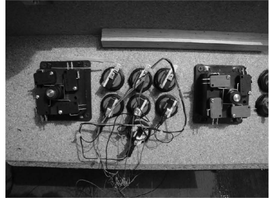
Instalación de botones
