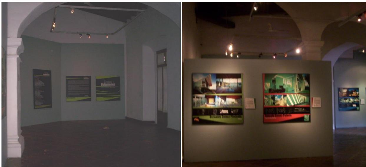
**Imagen No. 91,92.** Interior de la Sala José María Velasco. Se observa la presencia de los arcos y las columnas que fueron construidas en reemplazo de los muros de carga original, con el fin de unificar todos los ambientes en una gran sala de exposición alterando así la disposición de los espacios originales.
