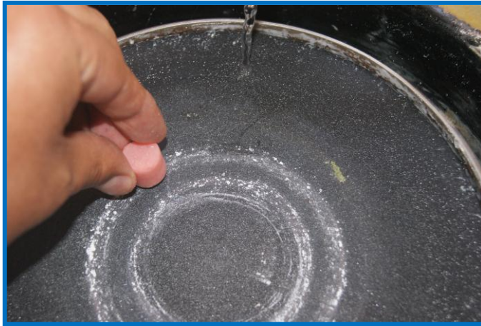
Imagen 2.3. Desgaste del esmalte con papel abrasivo de grano 600.
