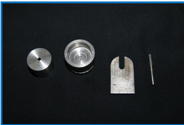
Imagen 3.2.Sistema de cilindro y pistón para desalojo.
