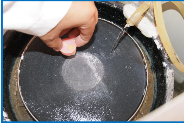
Imagen 1.4. Preparación del esmalte mediante abrasión con papel abrasivo grano 600.
