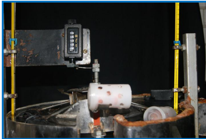
Imagen 2.8. Termociclador desarrollado en el laboratorio de materiales dentales.
