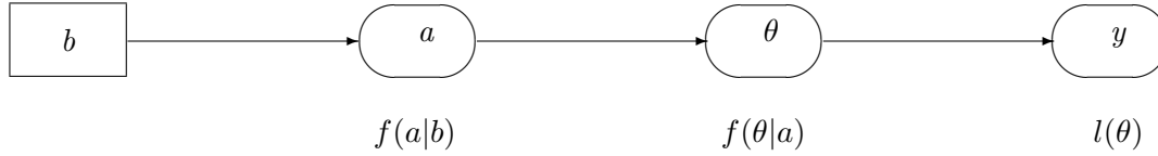
Figura 2.2: Representación gráfica de un modelo jerárquico Bayesiano de dos niveles. Los nodos cuadrados se refieren a parámetros constantes, nodos ovalados se refieren a componentes estocásticos del modelo.
