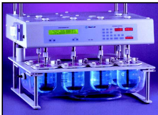
Figura 6. Aparato de disolución II, también llamado de paleta.
