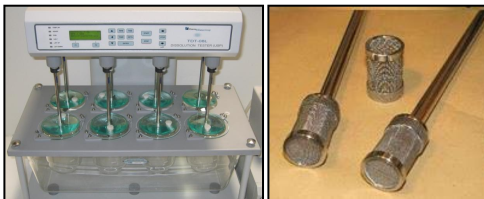
Figura 4. Aparato de disolución I, también llamado de canastilla.
