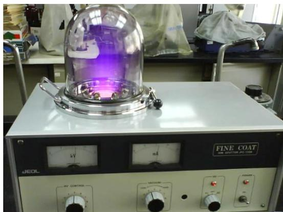
Fig. 10 Máquina ionizadora de oro para el recubrimiento de oro de las muestras.
