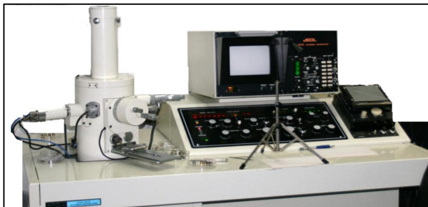
Fig.9 Microscopio electrónico de barrido. (Lab. Microscopia Electrónica UNAM, FESC-1)
