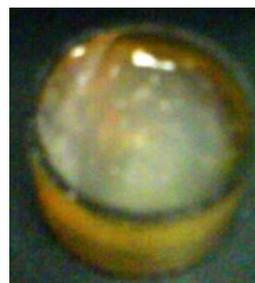
Fig.22 Termogel de Qn-PVA sin degradar
