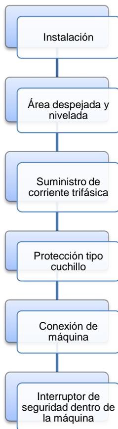
**Figura. 1.5.3.1 Proceso de Instalación de Maquinaria.**
