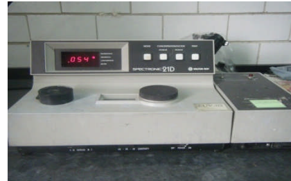
Figura 3.1 Muestras de lixiviados ácidos y espectrofotómetro utilizado
