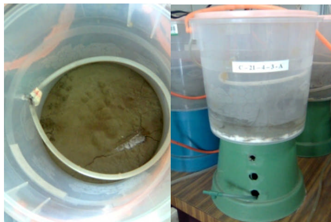
Figura 2.4 Fotografías de la celda de humedad: Vista superior y vista lateral utilizada para la generación de drenajes ácidos en pruebas de laboratorio
