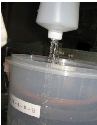
Figura 2.5 Riego de celda para generación de lixiviado
