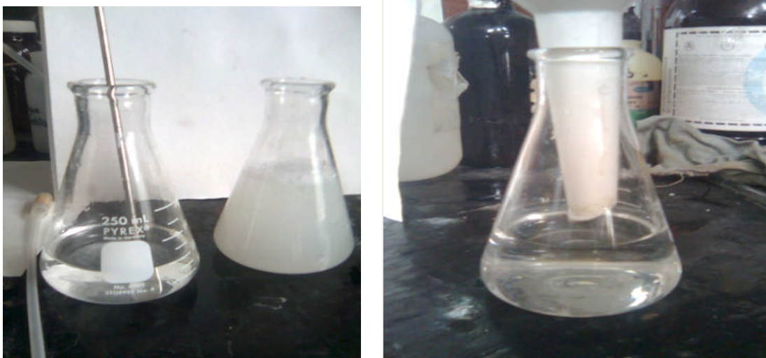
Figura 3.2 Formación de flóculos y filtrado
