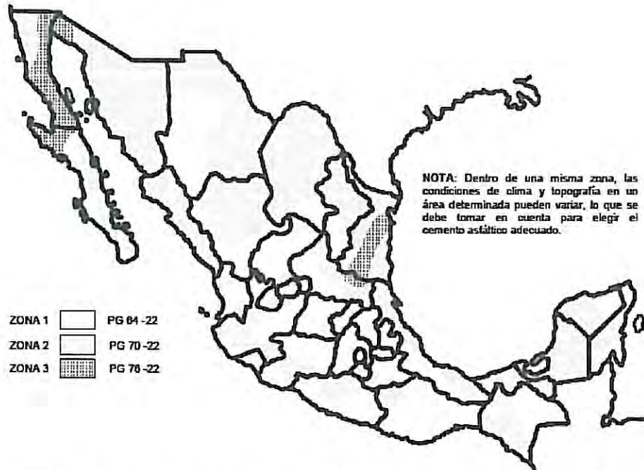
FIGURA 1.- Regiones geográficas para la utilización recomendable de cementos asfálticos Grado PG
