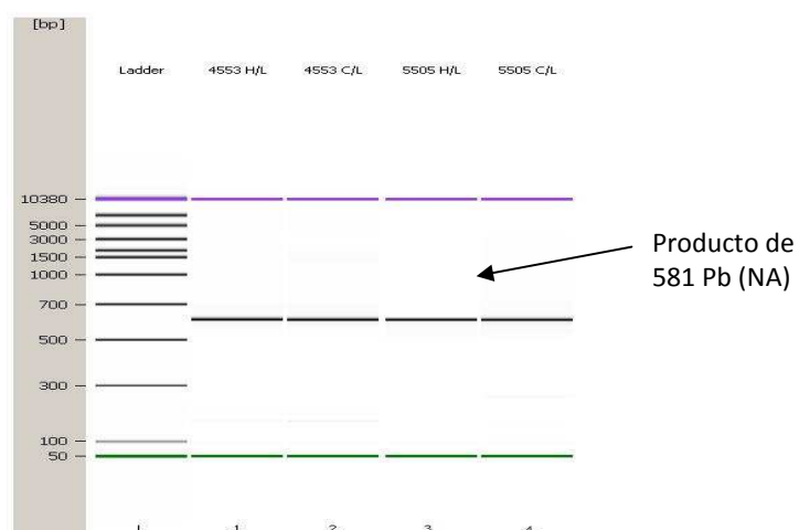
Fig. 13 Electroferograma del análisis de microfluidos con el Bioanalizador Agilent 2100 para la identificación de los productos de RT-PCR amplificados. El análisis se efectuó con un chip de DNA7500. Carril L) Marcador de peso molecular. Carril 1) 4553H. Carril 2) 4553C. Carril 3) 5505H y carril 4) 5505C.
