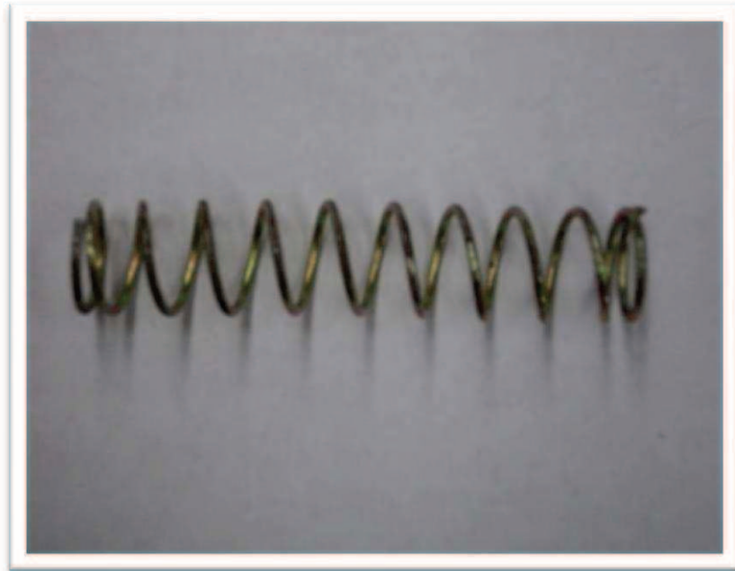
Figura 4.7. Resorte a compresión que es deflectado debido a la contracción del alambre con memoria de forma, al aumentar o disminuir la temperatura.
