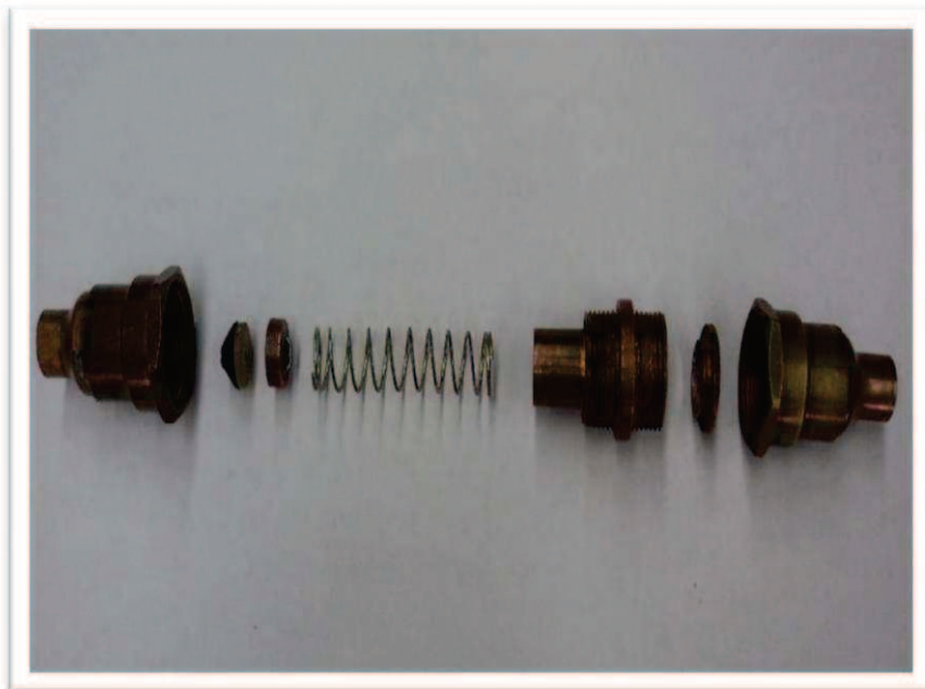
Figura 4.8. Explosivo del prototipo de válvula economizadora de agua que trabaja con un alambre con memoria de forma
