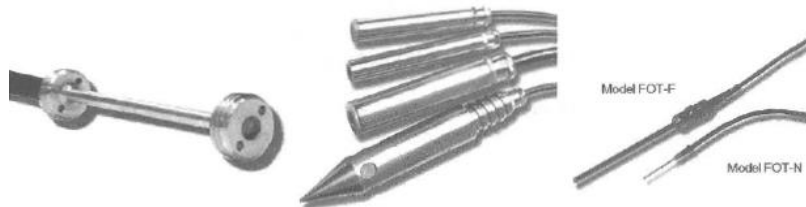
Figura 3.4: Sensores interferométricos Fabry-Perot, para medir esfuerzo, presión y temperatura (Branko, et al., 2007)
