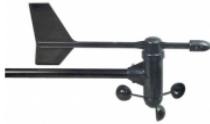
Figura 2.10: Anemómetro tipo Robinson.
