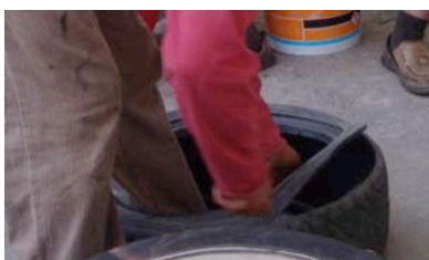
Figura 16. Muestra el corte de una de las caras de la llanta.
