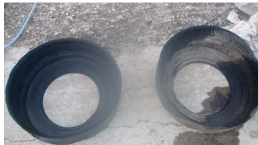
Figura 18. Muestra las llantas ya cortadas y volteadas, las caras de las llantas están desprovistas de tejido metálico, por lo que con una navaja afilada es posible de manera sencilla cortarlas (figura 16).
