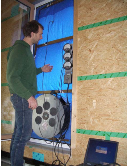
Ilustración 13: “Blower Door Test” en una casa de madera en Dresden, Alemania foto: A. Schumann, 2007
