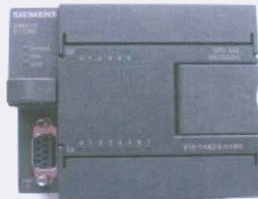
Fig. 1.1 PLC de 5 entradas 8 salidas marca Siemens
