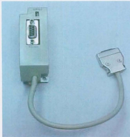
Fig. 1.6 Interfaz-Adaptador para la comunicación entre el ordenador (PC) y el autómeta (PLC)
