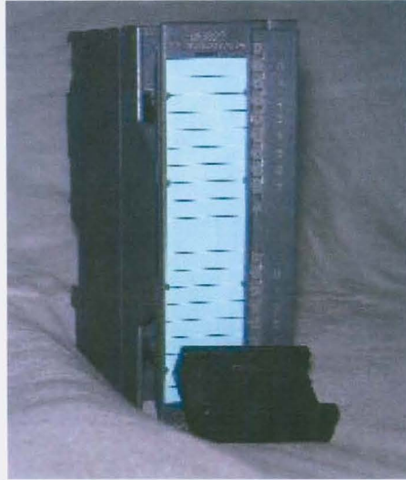
Fig. 1.5 D Módulo de entradas
