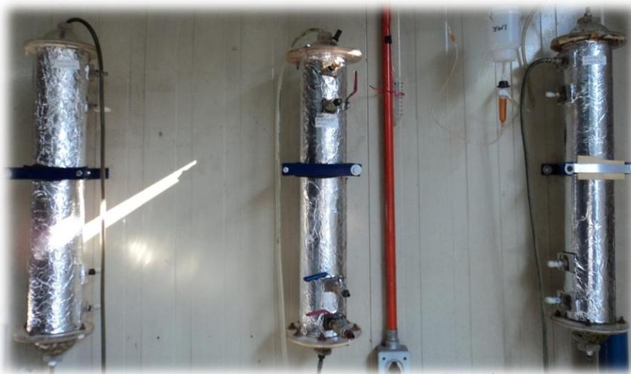
Figura 2.3 Biofiltros con volumen de 3.5 L
