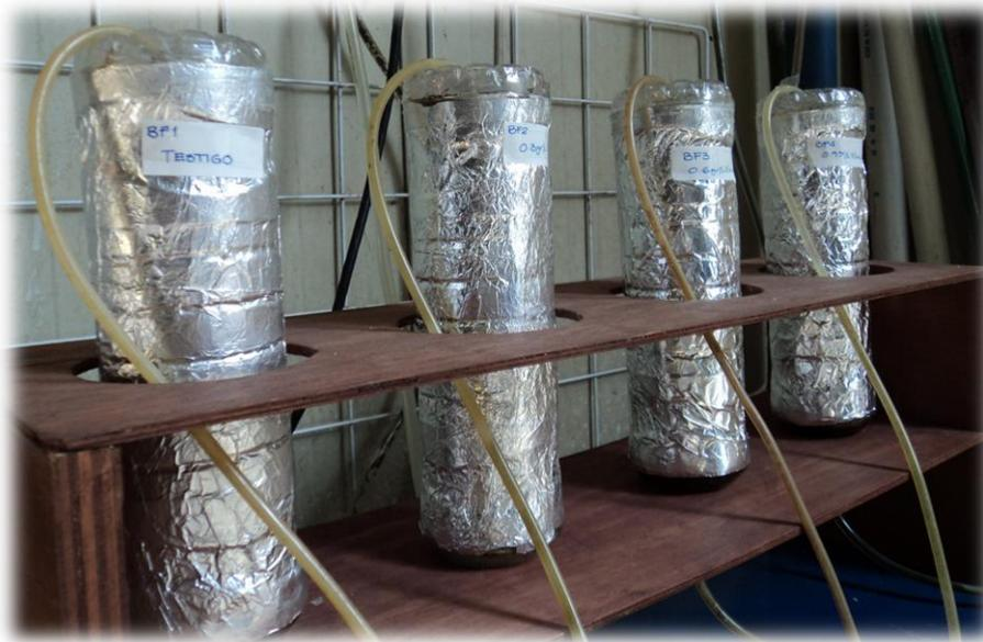
Figura 2.2 Biofiltros de volumen de 1 L
