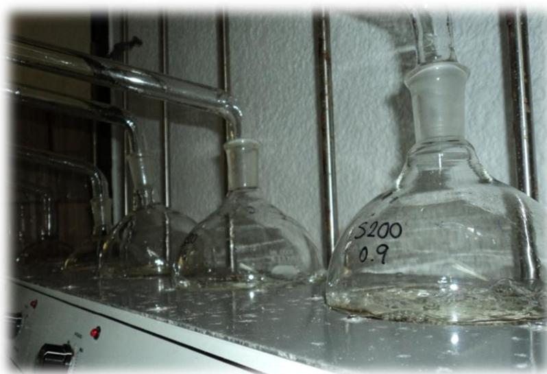
**Figura 2.9 Destilación de las muestras de fenol**
