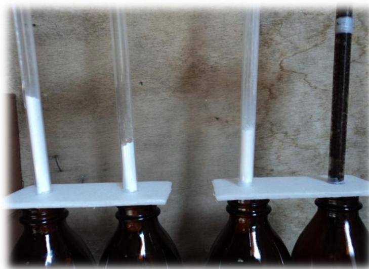
Figura 2.6 Columnas de adsorción
