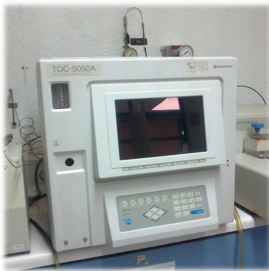
Figura 2.14 Equipo para la medición de COT
