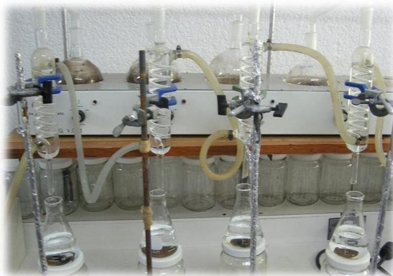
**Figura 2.8 Montaje del sistema de destilación**
