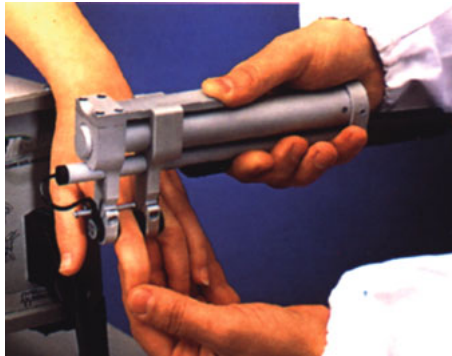
Figura 1.5.1: Dispositivo para medir la densidad en los dedos de la mano utilizando ultrasonido focalizado de manera transversal [18].
