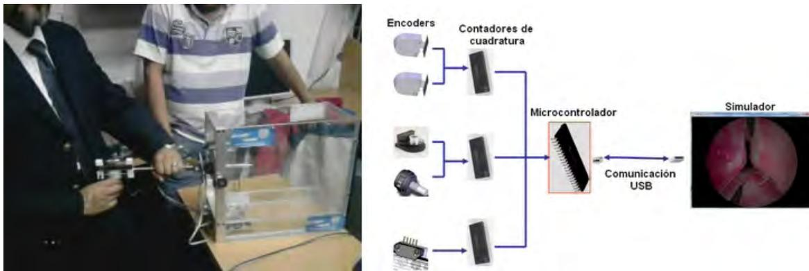
**Figura 2.16.** *Simulador de RTUP que implementa deformaciones y cortes sobre un modelo virtual de tetraedros. A la izquierda, interfaz mecatrónica de interacción. A la derecha, ambiente virtual.*
