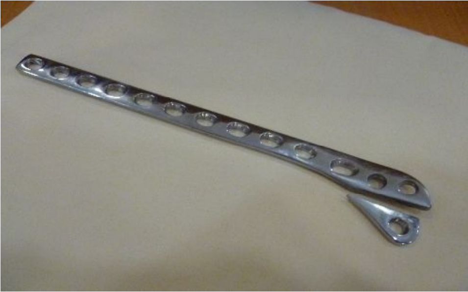
MODIFICACION DE PLACA DCP DE SOPORTE LATERAL DE MESETA TIBIAL, 48 HRS ANTES DE LA CIRUGIA
