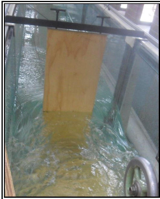
Figura 85. Formación de vórtices al interceptar el flujo en la pantalla ubicada a 0.75 m.
