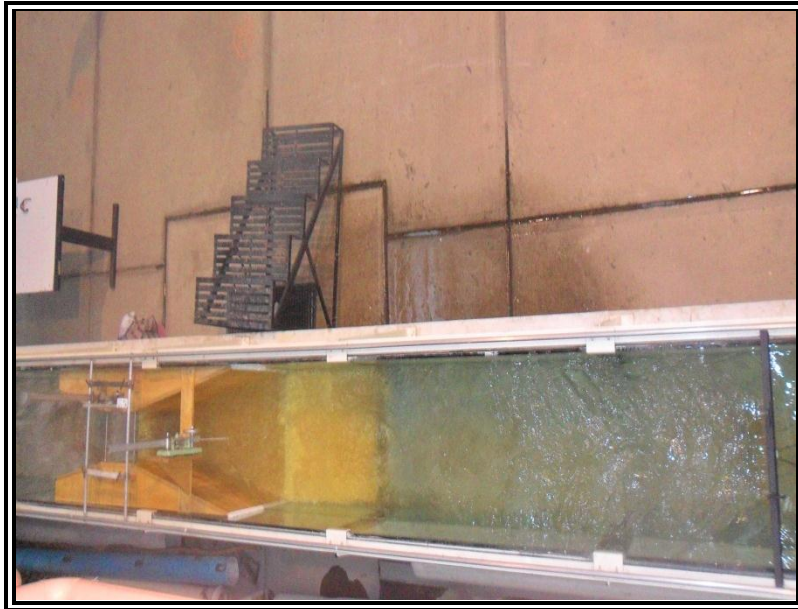
Figura 95. Colocación de la pantalla a 3.00 m antes del Parshall, vista en planta.
