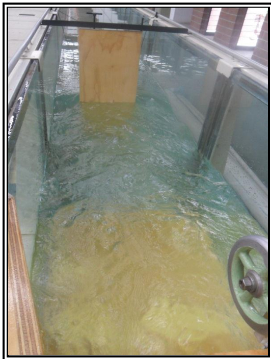
Figura 89. Formación de vórtices al interceptar el flujo en la pantalla ubicada a 1.53 m.
