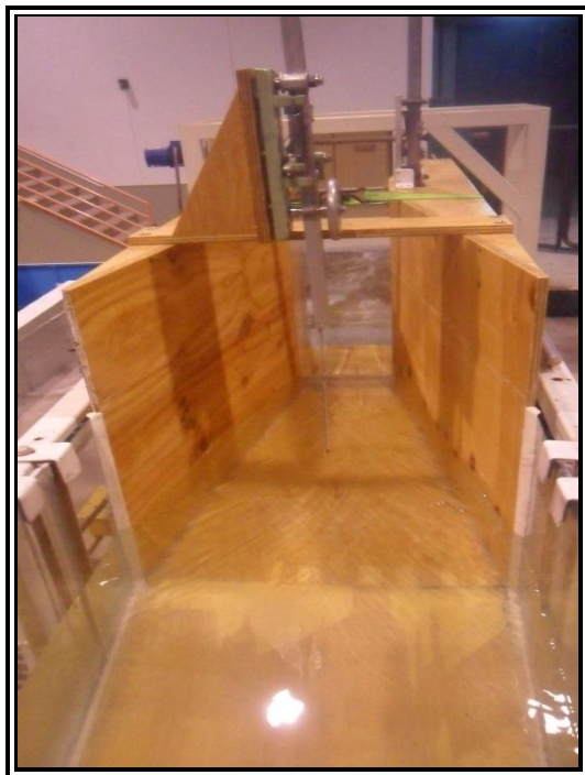
Figura 122. Generación de una pequeña turbulencia a la entrada al Parshall para S=0 .
