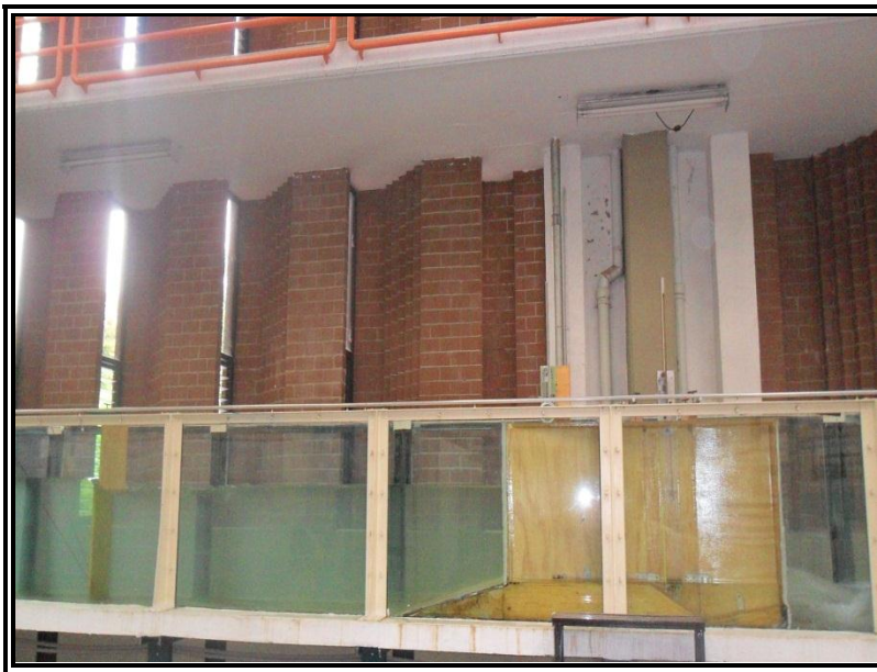
Figura 96. Colocación de la pantalla a 3.00 m antes del Parshall, vista de perfil.
