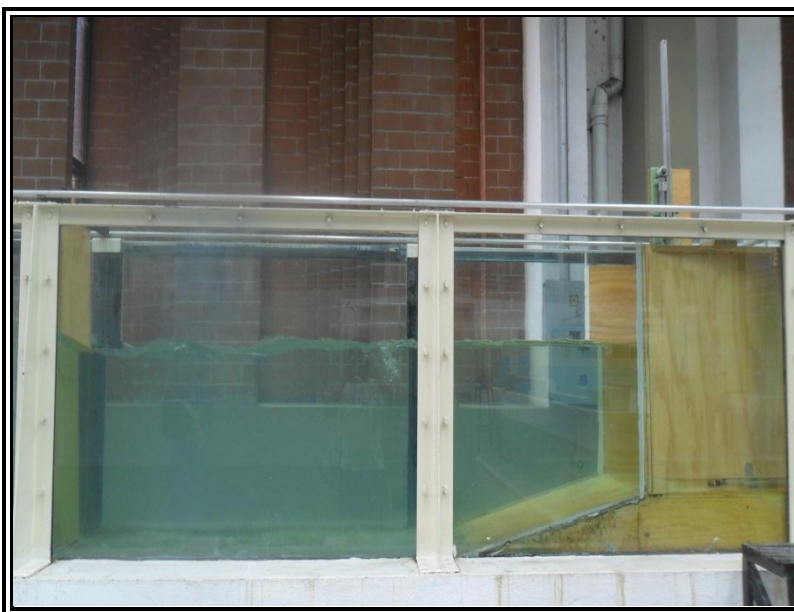
Figura 92. Colocación de la pantalla a 2.28 m antes del dispositivo, vista de perfil.
