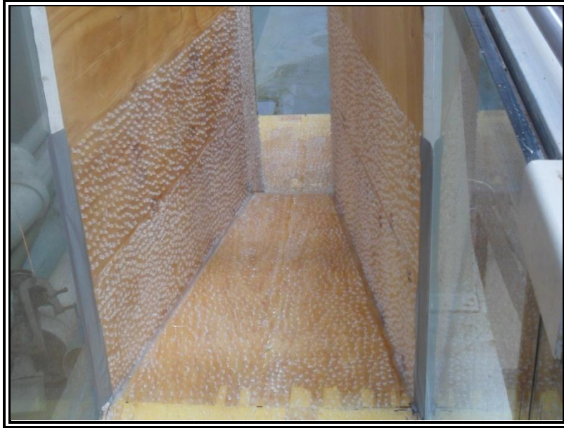
Figura 56. Rugosidad hecha con silicón de 4 mm de diámetro.
