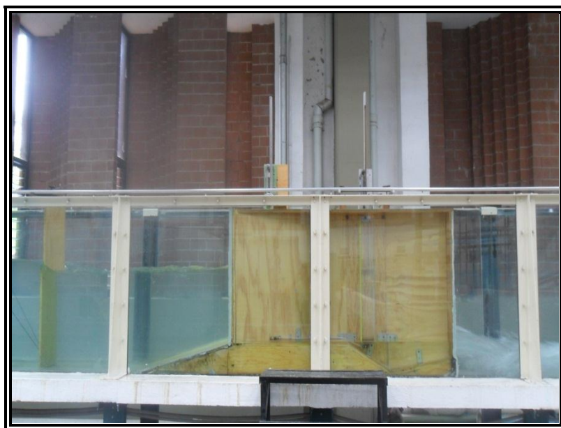
Figura 88. Colocación de la pantalla a 1.53 m antes del modelo, vista de perfil.
