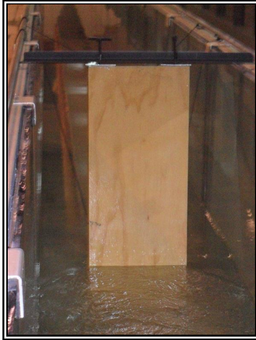
Figura 97. Formación de vórtices al interceptar el flujo en la pantalla ubicada a 3.00 m.
