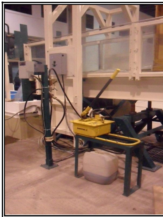
Figura 60. Mecanismos para ajustar la pendiente del canal.
