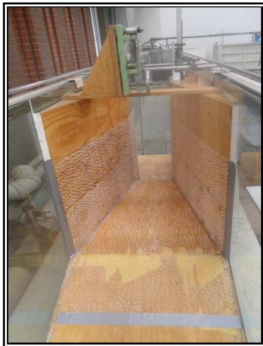
Figura 78. Rugosidad hecha con silicón de 6 mm de diámetro.
