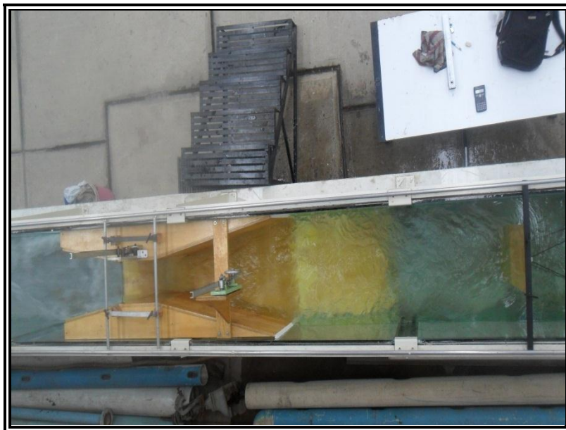
Figura 87. Colocación de la pantalla a 1.53 m antes del modelo, vista en planta.
