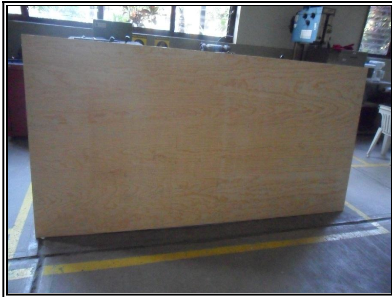
Figura 37. Hoja de triplay empleada para la construcción del dispositivo.
