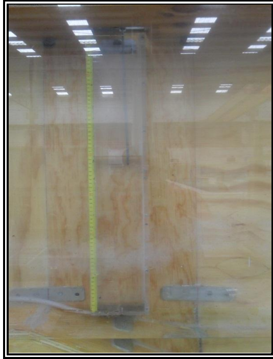
Figura 52. Pozo de lectura ubicado en la garganta del aforador.
