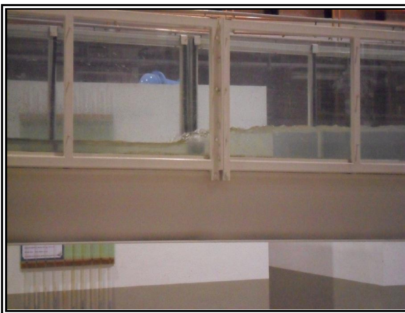
Figura 132. Formación de un salto hidráulico estacionario aguas arriba del aforador.
