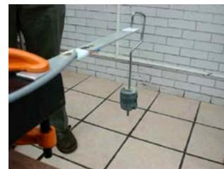
Fig. A4 Diferentes cargas en la prueba de tensión.
