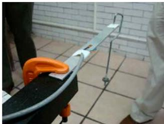
Fig. A3 Ubicación de la carga para la Prueba de tensión.
