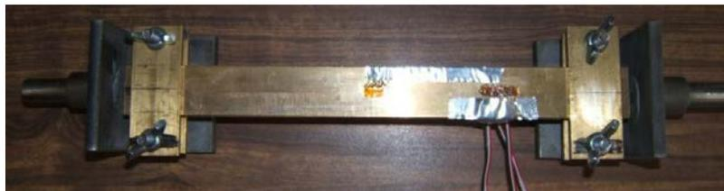
**Foto 4.4** Roseta pegada en la probeta de la sección transformada, viga en I de Latón.
