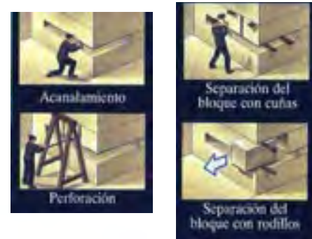
Imagen 95: Método de extracción de bloques de cantera. 16
