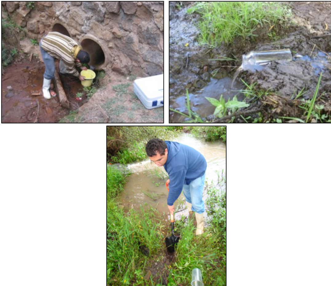
Figura 9. Estimación del Q por el método de relación volumen-tiempo.
