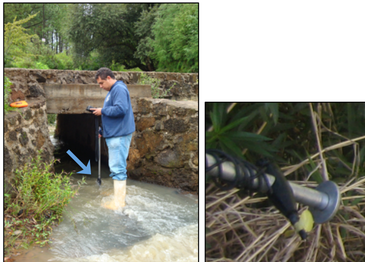
Figura 8. Estimación del Q por el método de área-velocidad.
