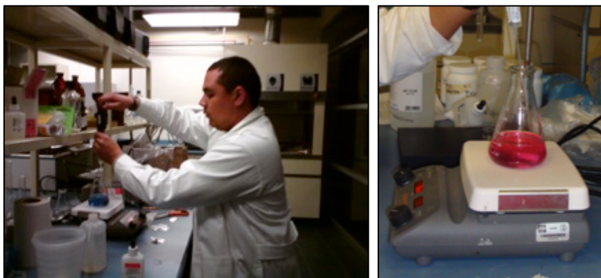
Figura 13. Determinación de la DT por el método de titulación con EDTA.
