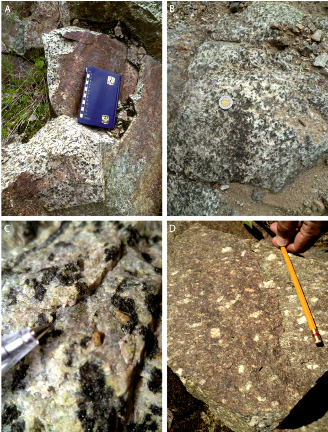
Fig. 4.2.1 Afloramientos de monzonita. A) Textura fanerítica de la monzonita B) zonas con mayor concentración de minerales máficos C) Titanitas de aproximadamente 3 mm en monzonita. Nótese la coloración verdosa alrededor de los minerales máficos. D) Fenocristales de feldespato potásico.
