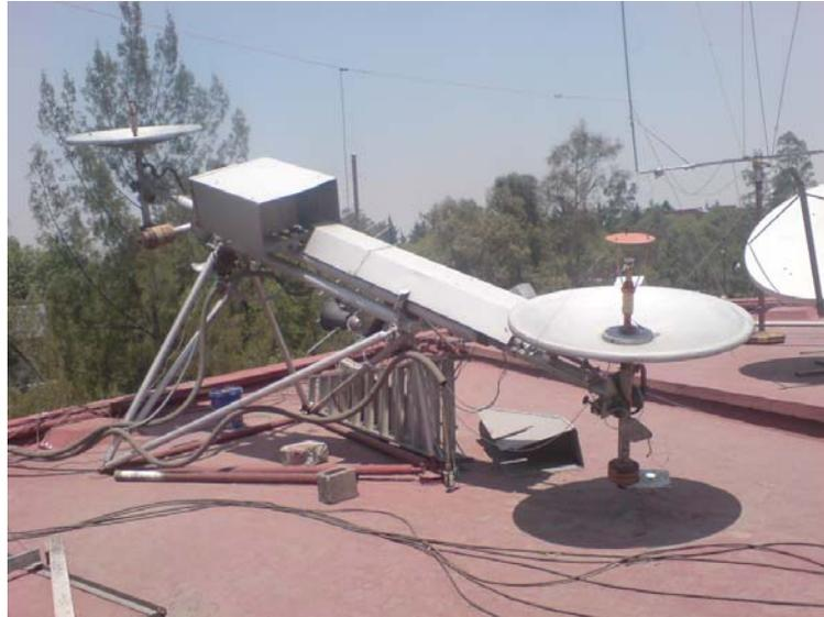
Imagen 1-16 Radio Interferómetro Solar RIS.
