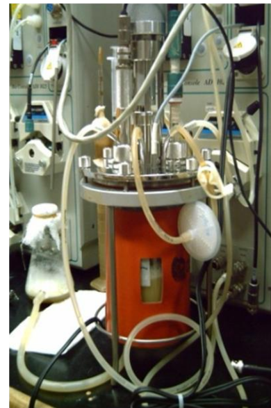
Figura 4. Esquema y fotografía del fermentador de 1 L
