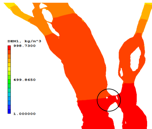
Figura 5.21 Tirante del Carrizal es mayor que el del Samaría para una velocidad de entrada de 0.026 \text{ m/s} , sin embargo no existe un redireccionamiento del flujo importante.
