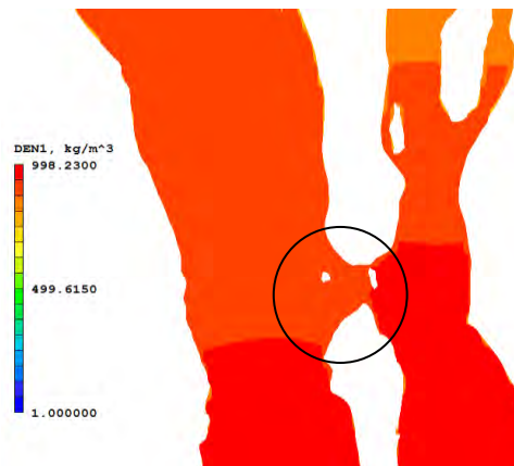
Figura 5.9 Tirante del Carrizal es mayor que el del Samaría para una velocidad de entrada de 0.052 m/s.
