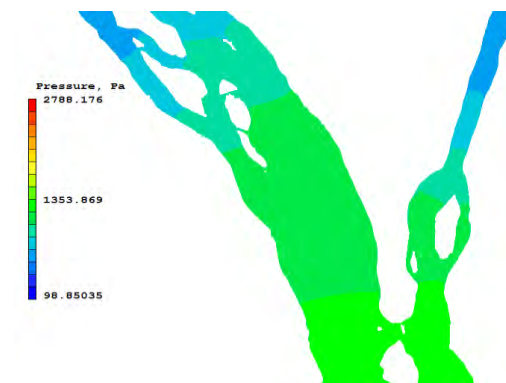
Figura 5.16 Contornos de presión para una velocidad de entrada de 0.039 m/s.
